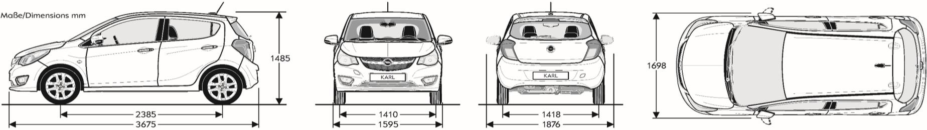
Breite mit eingeklappten Außenspiegeln 1698 mm
