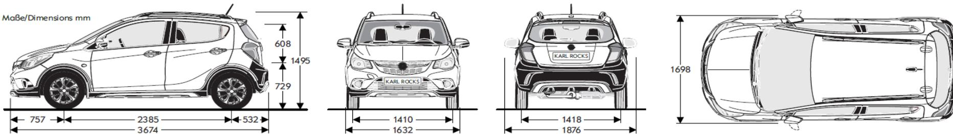
Breite mit eingeklappten Außenspiegeln 1698 mm
