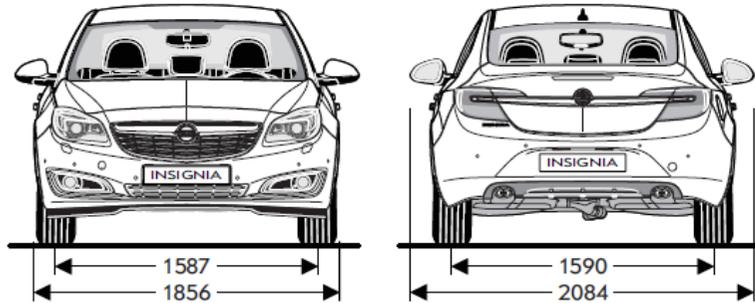
Breite mit eingeklappten Außenspiegeln 1858 mm
