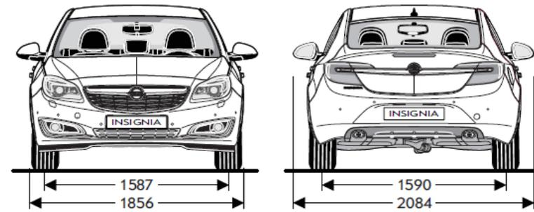
Breite mit eingeklappten Außenspiegeln 1858 mm
